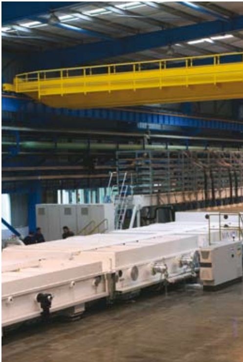
Glasbeschichtungsanlage für Flachglas mit LowE- und Solar-Control-Beschichtungen (Mit freundlicher Unterstützung der Von Ardenne Anlagentechnik GmbH)
