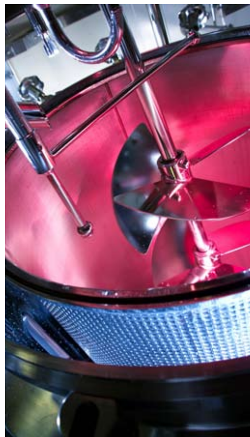
CEROBEAR Wälzlager beim Einsatz in bio-m ® Magnet-rührwerken der sterilen Verfahrenstechnik (Mit freundlicher Unterstützung der Zeta Biopharma GmbH)
